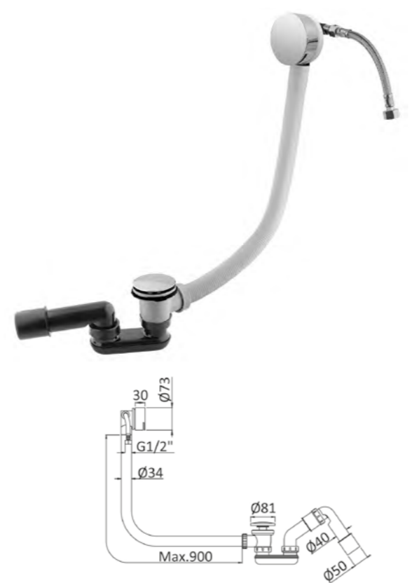
Слив перелив с наполнением ванны через перелив, донный клапан с системой "Клик-кляк"
